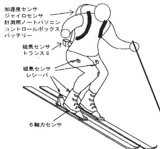
図3 スキーヤーに取り付けた各種センサ例 (長井力他, 引用文献10)
